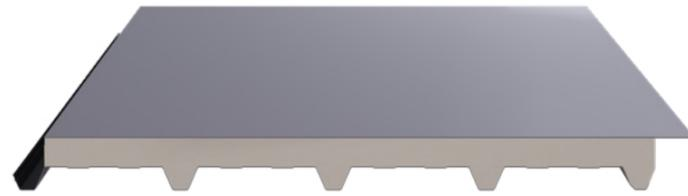
Progettato per rispondere alle molteplici esigenze dell'edilizia residenziale e industriale, RAIN Garden Mono è il pannello metallico autoportante grecato destinato alle coperture piane o con pendenza inferiore al 7%. Il pannello viene realizzato con il lato esterno piano al quale viene applicata una membrana sintetica in PVC, il lato interno realizzato in acciaio grecato.
