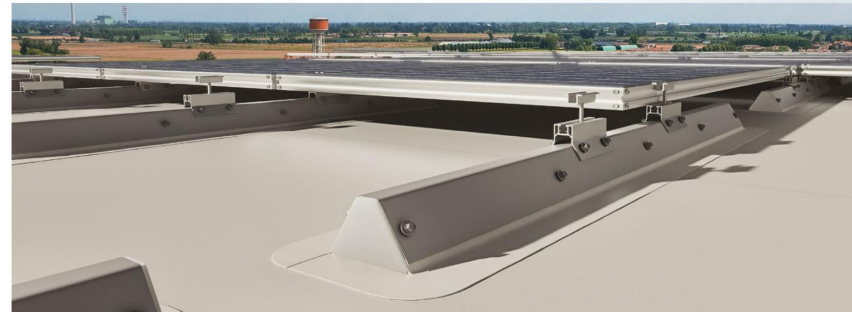
Per i tetti piani isolati con guaina, Nav system propone un sistema semplice composto da un profilo estruso in alluminio, con applicata una guaina che a scelta potrà essere in PVC, TPO o Bituminosa, ricoperta a sua volta da un pressopiegato in acciaio preverniciato.
